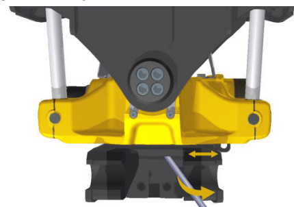
Afbeelding47. Draai de snelwissel naar rechts.
