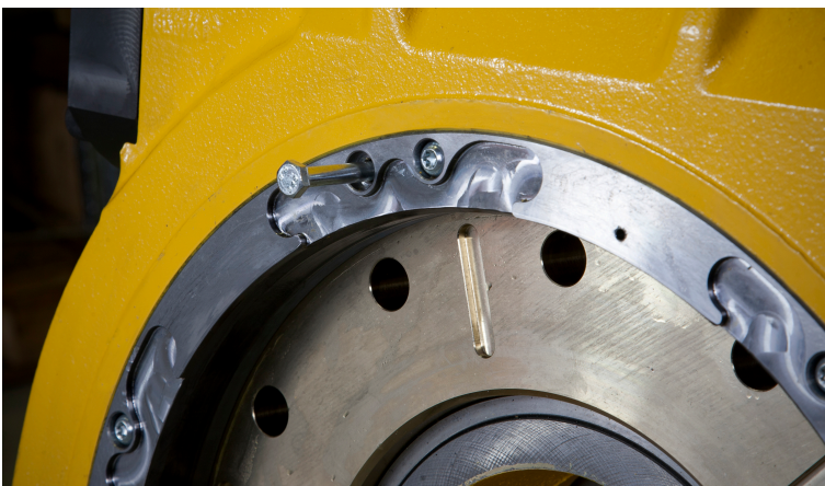
Afbeelding35. Schroef voor het draaien van de lagerring.
