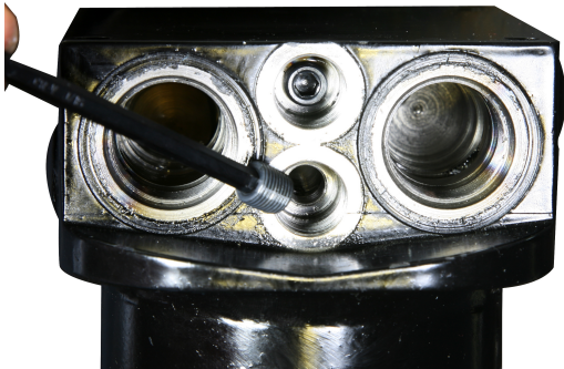
Afbeelding10. Afpluggen van de stuurleiding, optie 2.
